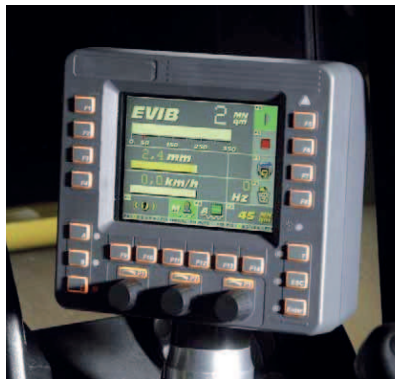
Eine klare Anzeige im Display (Design BW 177 BVC abweichend) zeigt dem Fahrer, wann der Boden optimal verdichtet ist.
