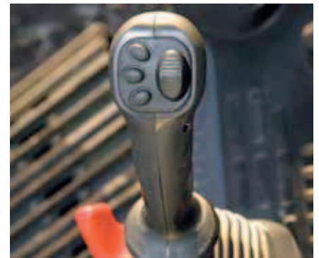
Joysticks mit Proportionalsteuerung für Anbaugeräte
