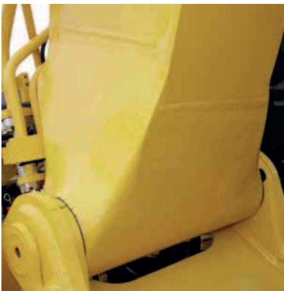
Auslegerfuß aus Stahlguss
