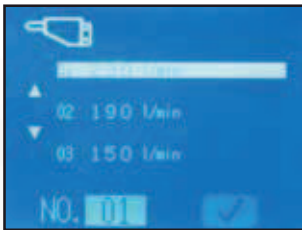
Einstellung Hydraulikölstrom in der Hammer-Betriebsart (B)
