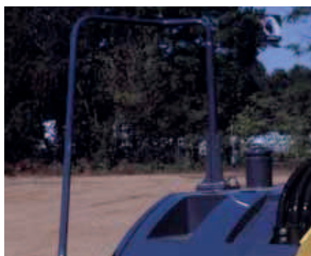
Großer Handlauf für sicheren Auf- und Abstieg.
