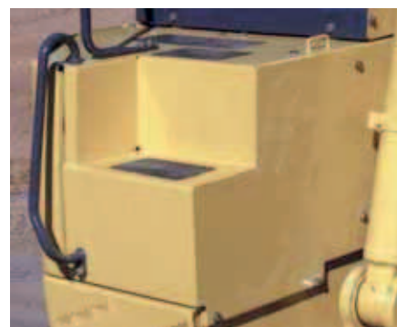
Aufstieg mit rutschfest beschichteten Stufen.
